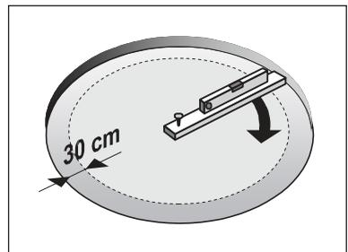
Aufpassen: Äußere 30 cm des Kreises müssen sich in einwandfreier Ebene befinden (siehe Abb. 2-9). Untere Kante der Wand des Schwimmbeckens muss waagrecht sein und unter der Wand dürfen sich keine Vertiefungen befinden. Widmen Sie dem die Zeit, dass Sie sicher sind, dass diese Fläche einwandfrei eben und waagrecht ist.
