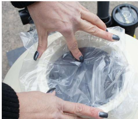
Bild 4a – Steigrohr zur Sandbefüllung des Filters abdecken
