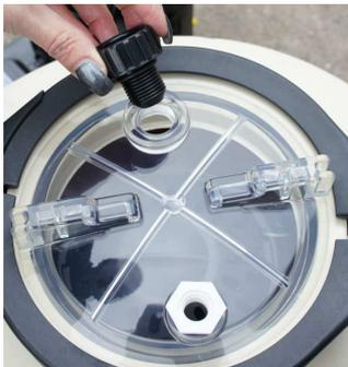
Bild 7 a Entlüftung einschrauben
