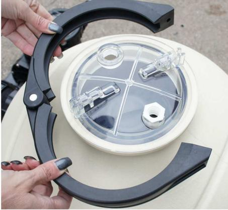
Bild 5 – Rand Filter säubern, Dichtung auflegen und Deckel mit Spannring montieren
